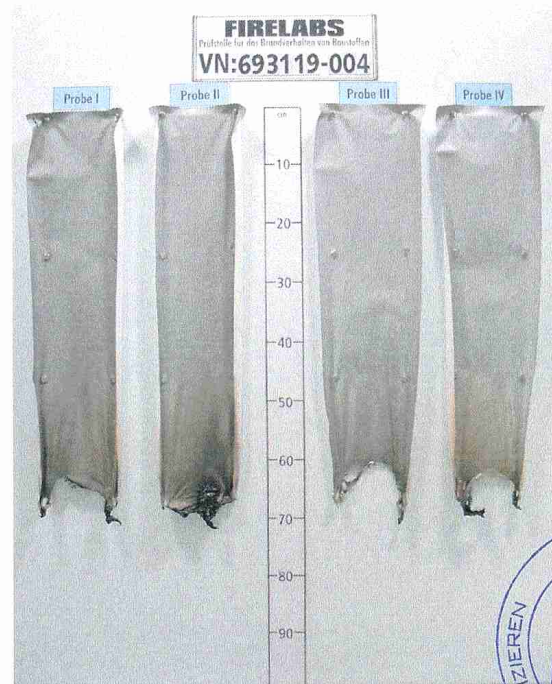
Bild 8 Aussehen des Probekörpers nach dem Brandversuch
