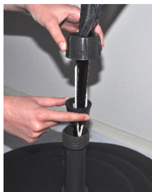
9. Plaats het geheel op het opzetstuk en draai de grote ring weer vast.
